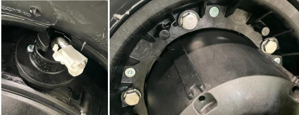
1/ Freilauf-Blockierung demontieren, 4x Schraube 4x14, Torx 20 Verlängerung. Dann einen neuen in umgekehrter Reihenfolge einbauen.
